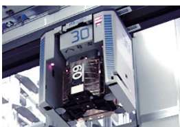
これは半導体搬送システムです。半導体は、ホコリやチリが限りなく少ないクリーン環境で作られます。工場の中には人はいません。そこで、天井にレール(図中の白い線)を引いて、ロボット(図中の黄色い丸印)で荷物を運びます。
