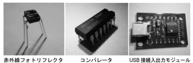
図8 装置作製に必要な材料
